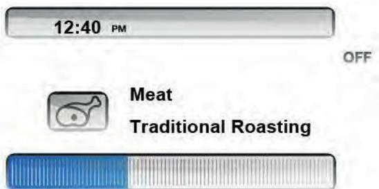
O painel de controle irá mostrar o tempo restante até o final da sequência de cocção. O forno irá desligar no final do ciclo de cocção programado. O forno irá mostrar END OF COOKING – BUON APPETITO! (FINAL DE COCCÇÃO – BOM APETITE!). O final da cocção será assinalado por uma campainha.
